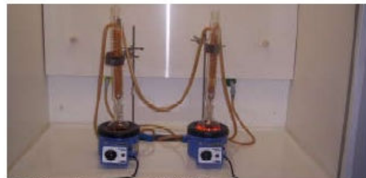
Fig. 2 Bagno di prova secondo UNI EN 579
